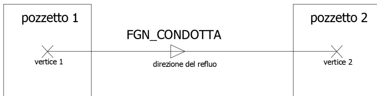
Figura 22 – Schema di disegno in GIS – Esempio di rappresentazione del verso di una condotta
